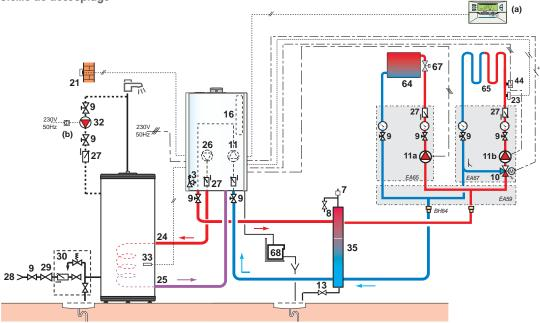
Installation d'une MC... LP avec 1 circuit radiateurs et 1 circuit avec vanne mélangeuse + 1 système solaire DIETRISOL pour la préparation de l'ecs
