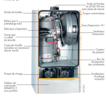
Détails Corps de chauffe avec brûleur gaz et ventilateur équipant les différents modèles MC
