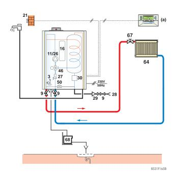
Installation d'une MC .. LP/BS 80 avec 1 circuit direct "radiateurs" + 1 circuit avec vanne mélangeuse (par l'intermédiaire du module hydraulique compact - colis EA 104)
