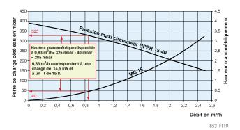
Hauteur manométrique disponible du circulateur chauffage de type Grundfos UPER 15-60 équipant les MC 25, MC 25 LP, 25 MI, 25 BIC et MC 25 LP/BS.
