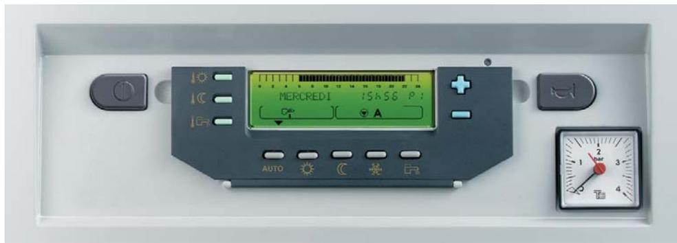
Le tableau de commande DIEMATIC 3 intègre d'origine une régulation électronique programmable qui module la température de la chaudière par action sur le brûleur. La puissance du brûleur est modulée en fonction de la température extérieure et éventuellement de la température ambiante par raccordement d'une commande à distance interactive CDI 2 ou d'une commande à distance avec sonde d'ambiance (option).
