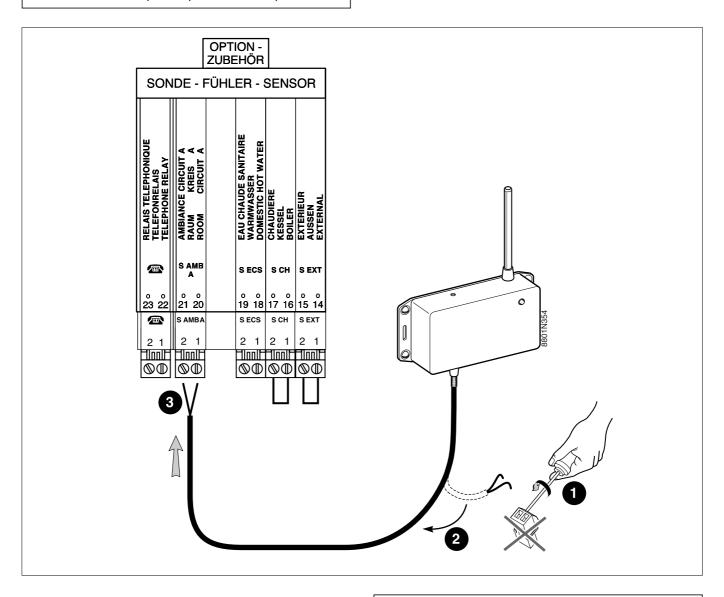
Supprimer le connecteur du câble du boîtier émetteur/récepteur.
