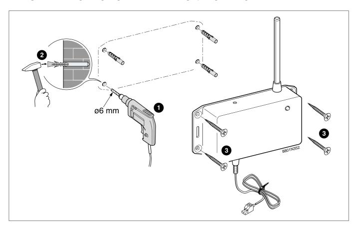
Le boîtier émetteur/récepteur doit être fixé au mur à proximité de la chaudière pour permettre le raccordement dans le tableau de commande de cette dernière. Utiliser les 4 vis + 4 chevilles livrées.
