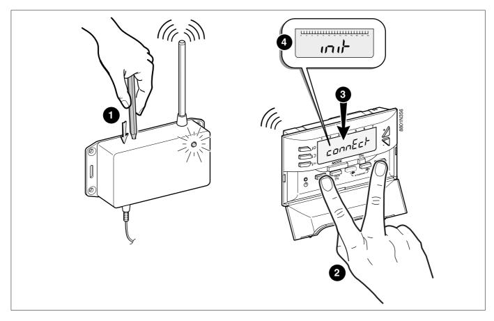
Chaque commande à distance intègre d'usine un numéro d'identification unique qui permet au boîtier émetteur/récepteur de reconnaître la commande à distance qui lui est attribuée. Ce numéro d'identification est transmis au boîtier émetteur/récepteur par la séquence d'appairage décrite ci-après :
