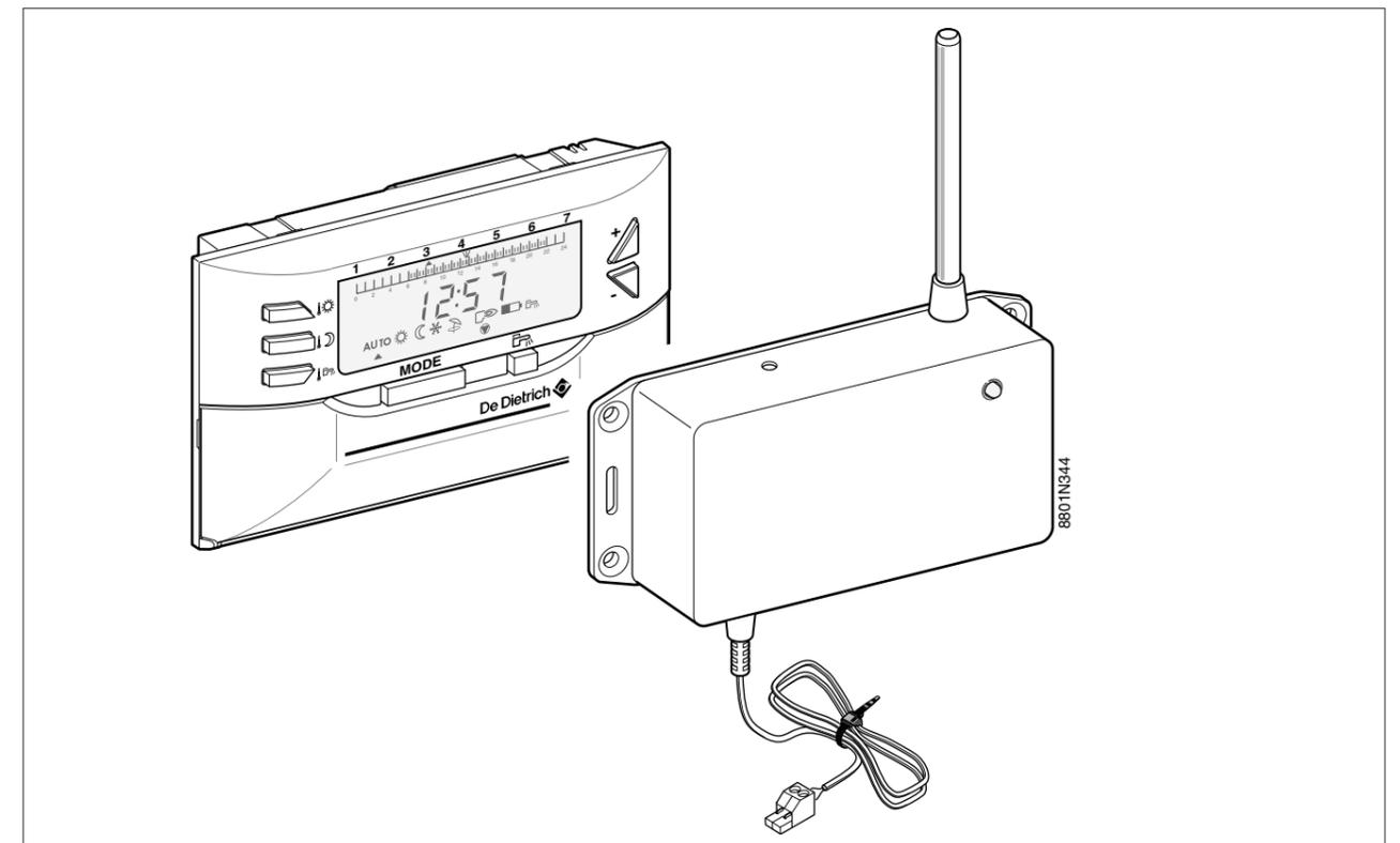
La commande à distance sans fil Easyradio à transmission radio assure la régulation et la programmation hebdomadaire du chauffage.
